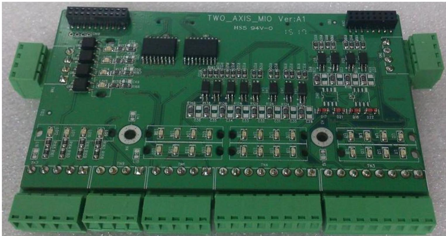
IO 卡：具 16 Input / 16 Output (400mA)
